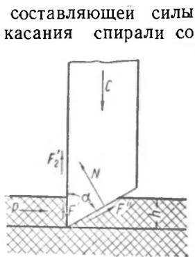
Рис. 4. Схема приложения сил трения к коронке, армированной по передней грани
