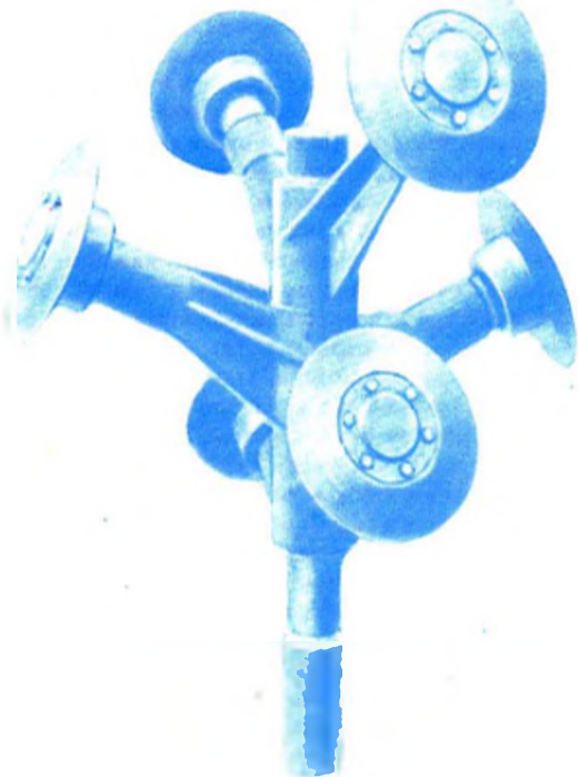
Рис. 2. Исполнительный орган для бурения углеспускной скважины диаметром 1500 мм
