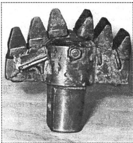
Рис. 2. Режущее буровое долото КузГТУ, оснащенное типовыми породными резцами РК-8Б
