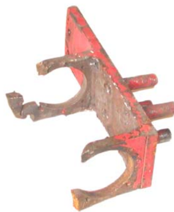
Рис. 2. Подшипниковые опоры устройства РП-2К, поврежденные при посадке гидростойки на жестко
