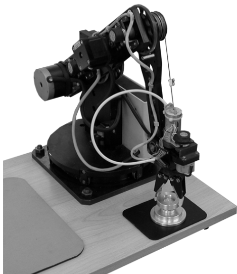
Рисунок 8 – Сборочный стенд с техническим зрением (окончание сборки)
