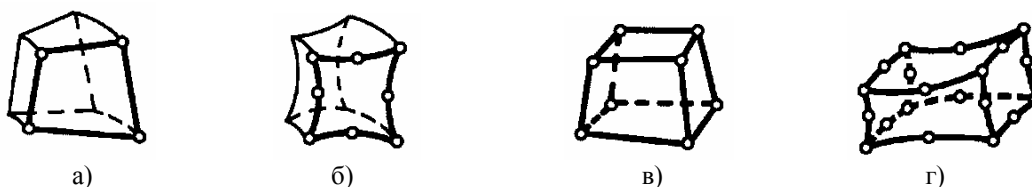
Рис. 1. Типы конечных элементов: а) двумерный линейный четырёхузловой; б) двумерный квадратичный восьмиузловой; в) трёхмерный линейный восьмиузловой; г) трёхмерный квадратичный двадцатиузловой
