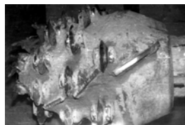
б) Исполнительный орган проходческого комбайна
