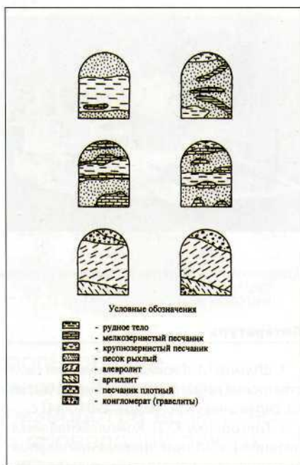
Рис. 4. Конфигурация залегания пород в плоскости забоя
