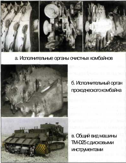
Рис.3. Варианты исполнительных органов с дисковыми инструментами
