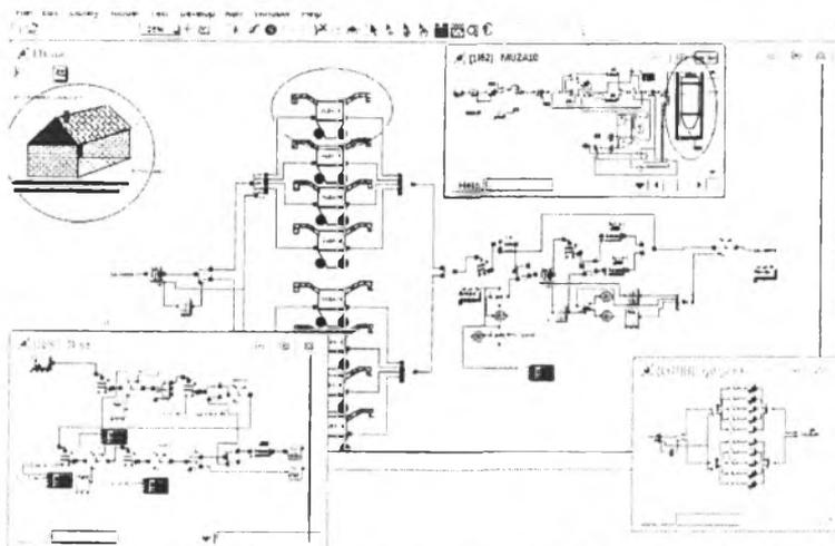
Рис. 2. Модель транспортно-складской системы ЭТК в среде имитационного моделирования Extend 6.0®
