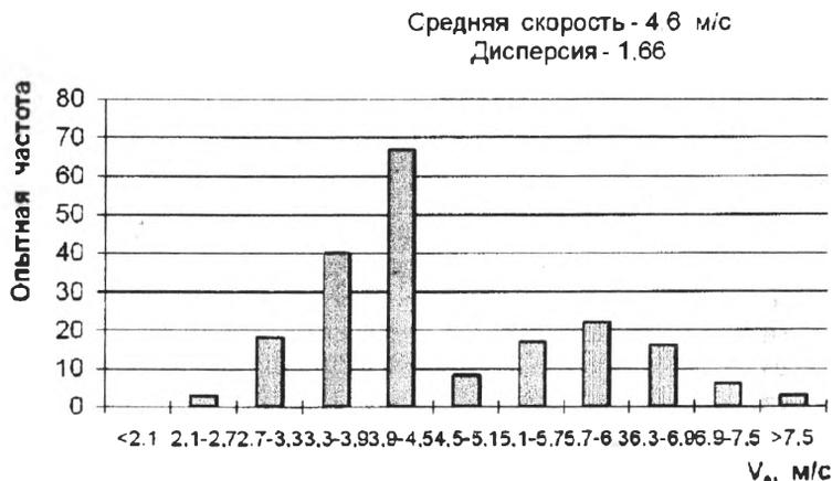
Рис. 4. Распределение скорости движения автосамосвалов на подъеме.
