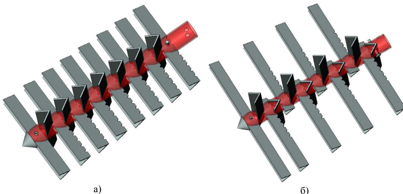
Рис.2. Адаптивные лопастные секции бурового става с минимальным (а) и максимальным (б) превышениями лопастей относительно поверхности вала
