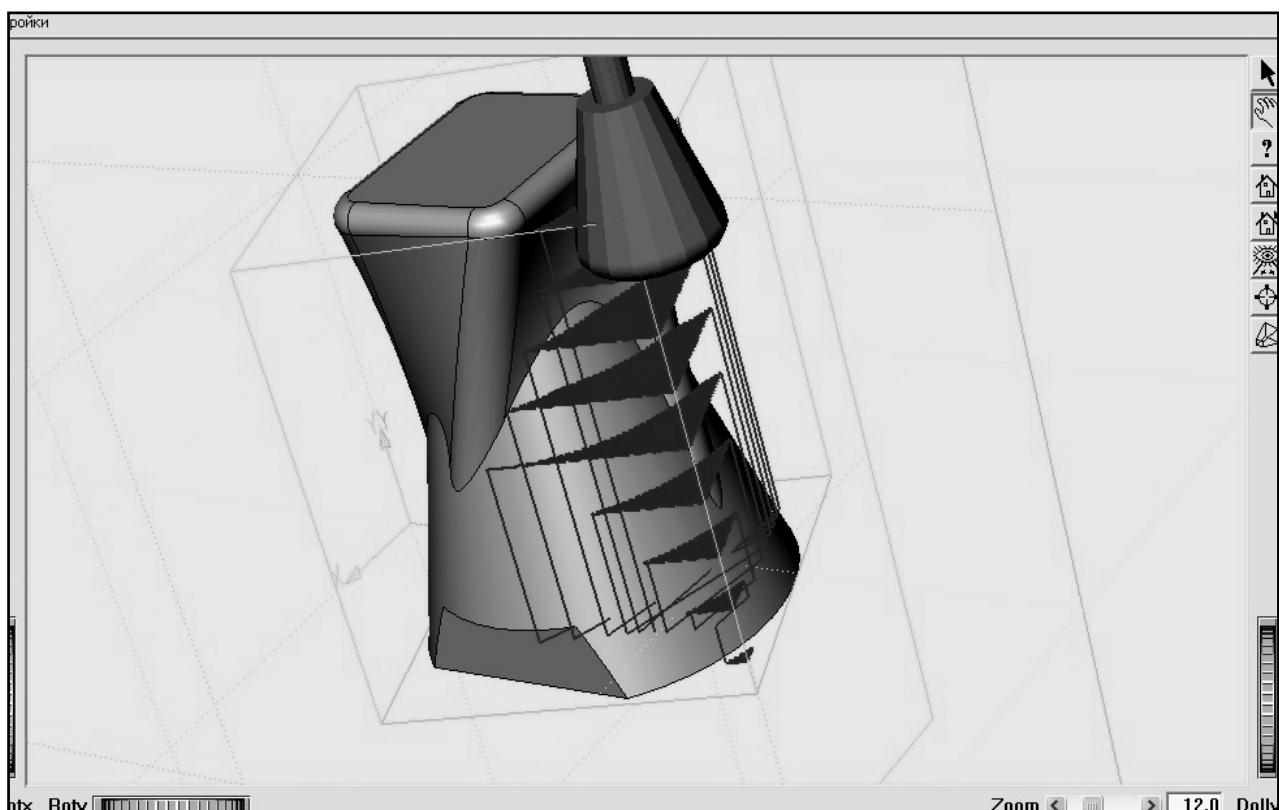
Рис. 2. Моделирование траектории обработки посадочной поверхности винтового адаптера в среде T-Flex ЧПУ
