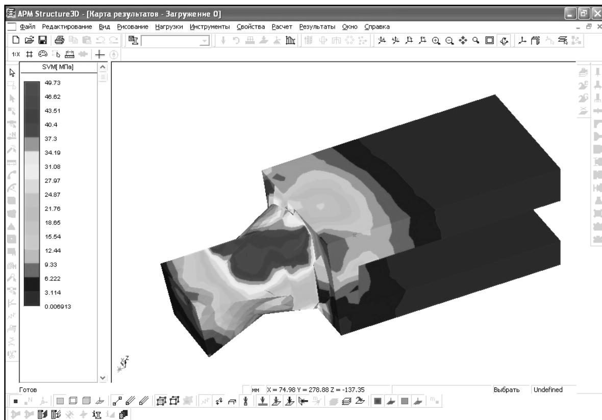
*Рис.1. Пример моделирования напряженно-деформированного состояния винтового адаптера в среде конечно-элементного анализа APM WinMachine*
