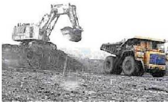
Рис. 1. Установка автосамосвала под погрузку при полной загрузке ковша экскаватора с подъемом на высоту погрузки (разрез «Краснобродский»)
