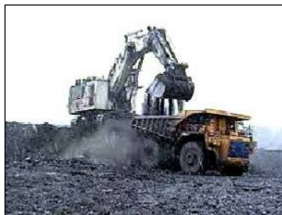
Рис. 2. Разгрузка ковша экскаватора в кузов автосамосвала при нижней погрузке (разрез «Караканский»)
