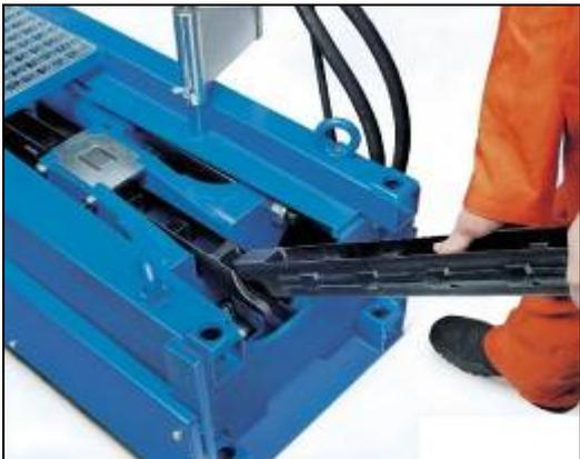
Рис. 2. Сборка буровых штанг по технологии Quicklock
