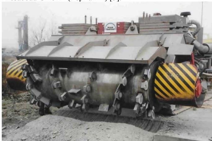
Рис. 3. Общий вид рабочего органа машины ТМ-D25
