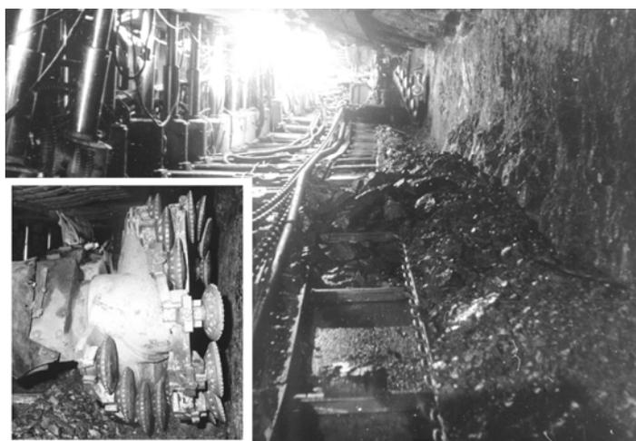
Рис. 2. Производственные испытания очистного механизированного комплекса для добычи руды и общий вид опытного образца рабочего органа ШДИ-1250М
