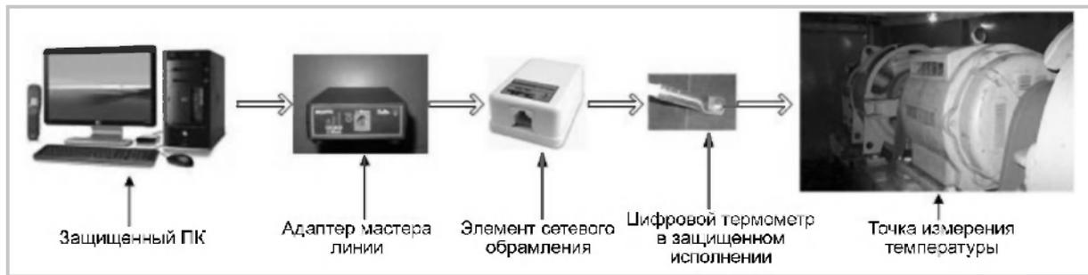
Рис. 5. Расположение элементов комплекса контроля температуры
