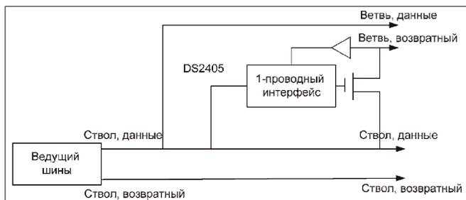
Рис. 8. Схема коммутации ветвей сети *1-Wire*
