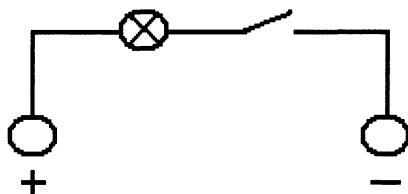
**Рис. 7. Электрическая схема подачи сигнала**
