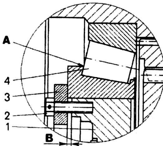
**Рис. 9. Проверка зазоров:** 1 - корпус редуктора, 2 - болт регулировочный, 3 - кольцо упорное, 4 – подшипник, А - место установки шупа; В – зазор
