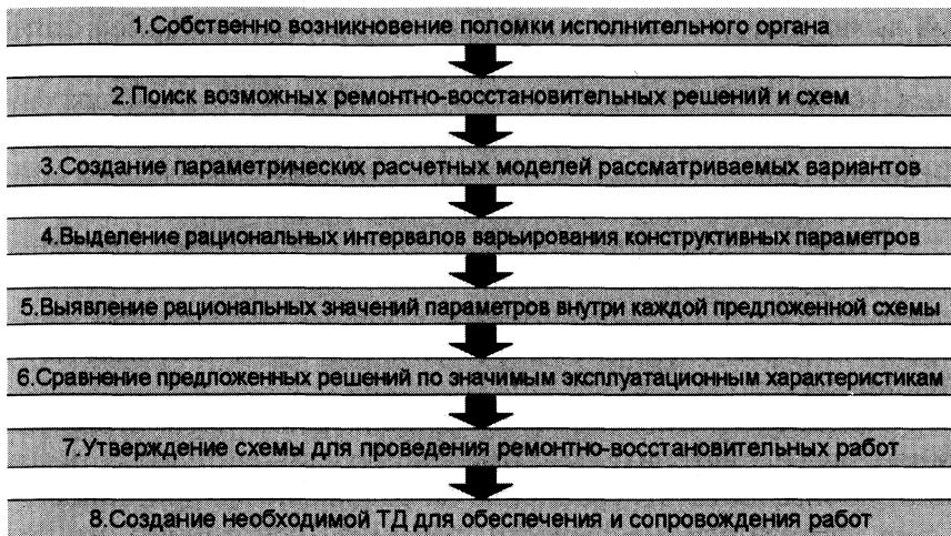
**Рис. 1. Схема последовательности действий по алгоритму**
