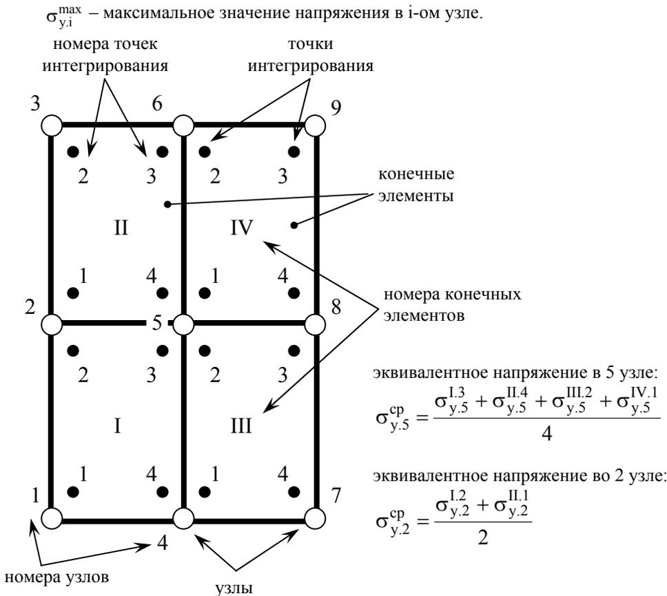
Рис. 1. Схема определения показателя плотности конечно-элементной сетки
