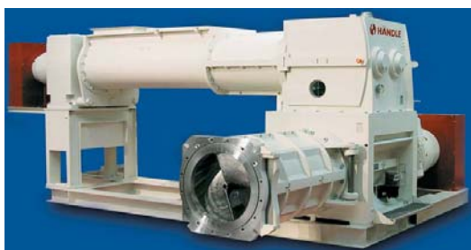
Рис. 1. Машина Futura II E56a/50 для производства окускованного топлива работающая по принципу шнекового пресса
