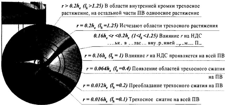
**Рис. 6. Расположение характерных концентрических зон на поверхности забоя**
