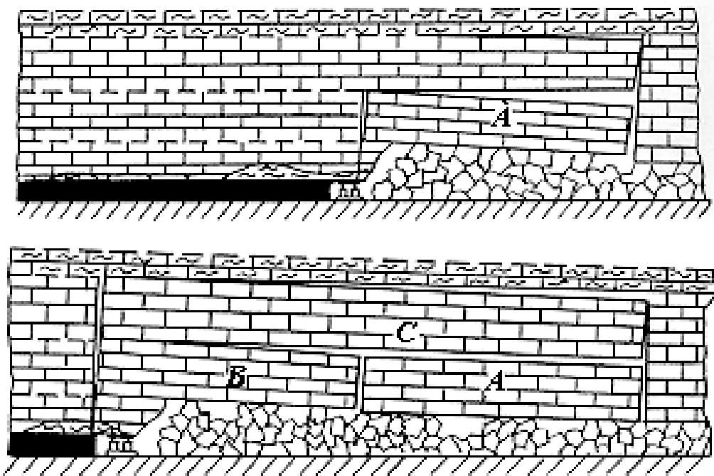
Рис. 1. Характер деформации подработанной толщи при одностадийном (а) и двустадийном (б) проявлении вторичных осадок
