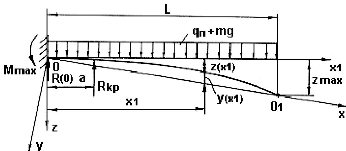
Рис. 3. Расчётная схема определения прогибов блока основной кровли в период, предшествующий проявлению осадки
