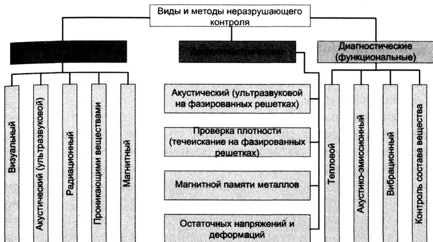
**Рис. 12. Методы диагностирования горных машин**
