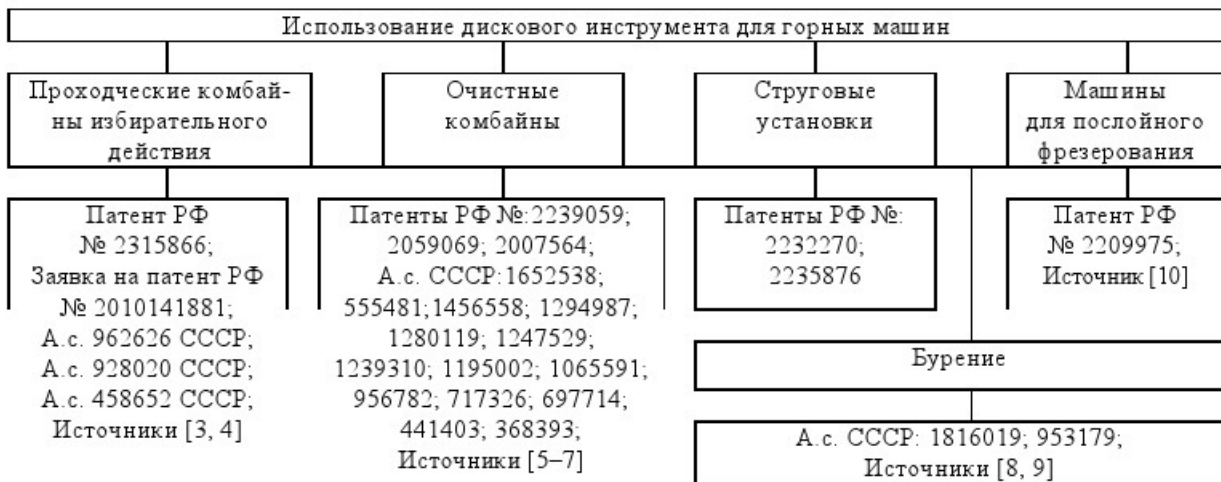
Рис. 8. Обзор технических решений по использованию дискового инструмента в горных машинах
