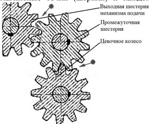
Рис. 2. Расположение точек смазки
