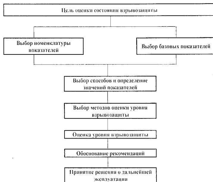
Рис.1 Алгоритм анализа состояния взрывозащиты рудничного взрывозащищенного электрооборудования
