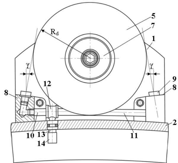
Рис. 2. Размещение устройства пылеподавления перед трехгранной призмой с дисковым инструментом
