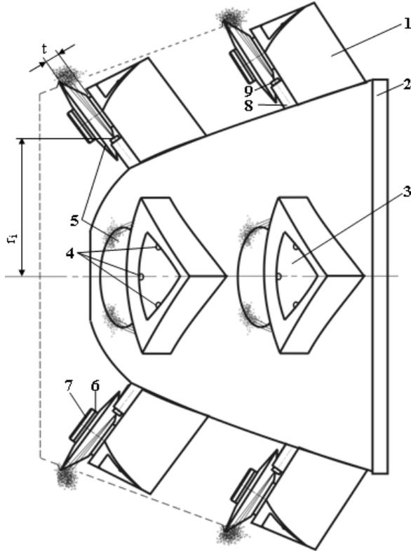
Рис. 1. Общий вид реверсивной коронки с устройством пылеподавления
