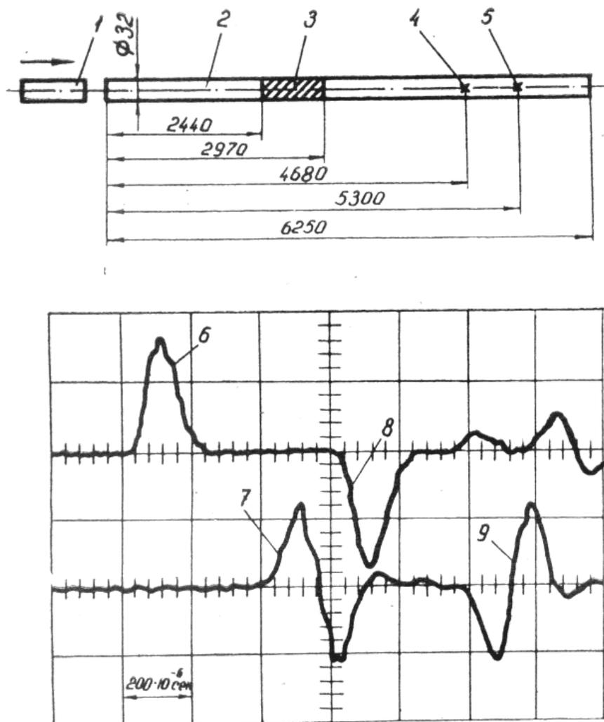
Рис. 1. Схема ударной системы с естественно закрученным стержнем ( $\alpha=45^\circ$ ) и осциллограммы осевого усилия и крутящего момента. 1-боек; 2-штанга; 3-естественно закрученный стержень; 4-датчик осевого усилия; 5-датчик крутящего момента; 6-осевой импульс; 7- импульс крутящего момента; 8-отраженный осевой импульс; 9-отраженный импульс крутящего момента
