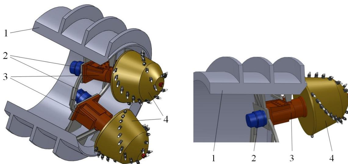
Рисунок 3. Компонентная схема корончатого ИО геохода:
