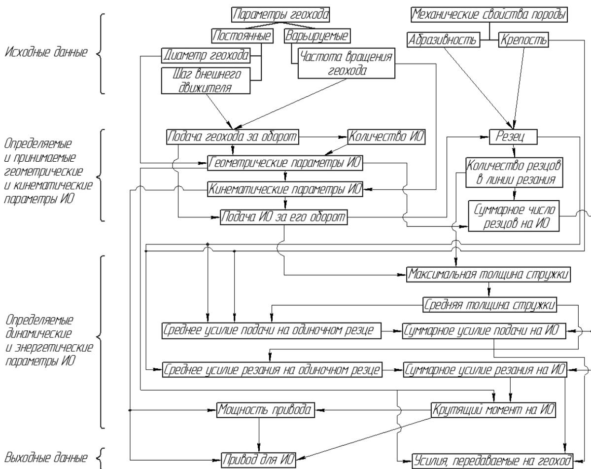
Рисунок 2. Схема связей параметров геохода и исполнительного органа.
