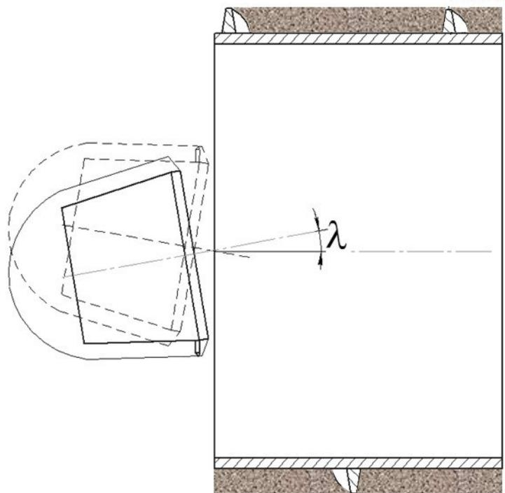
Рисунок 1. Схема корончатого исполнительного органа:
