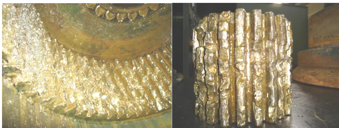
Рис. 4. Дефекты зубчатой передачи в волновом редукторе резания комбайна СМ-130
