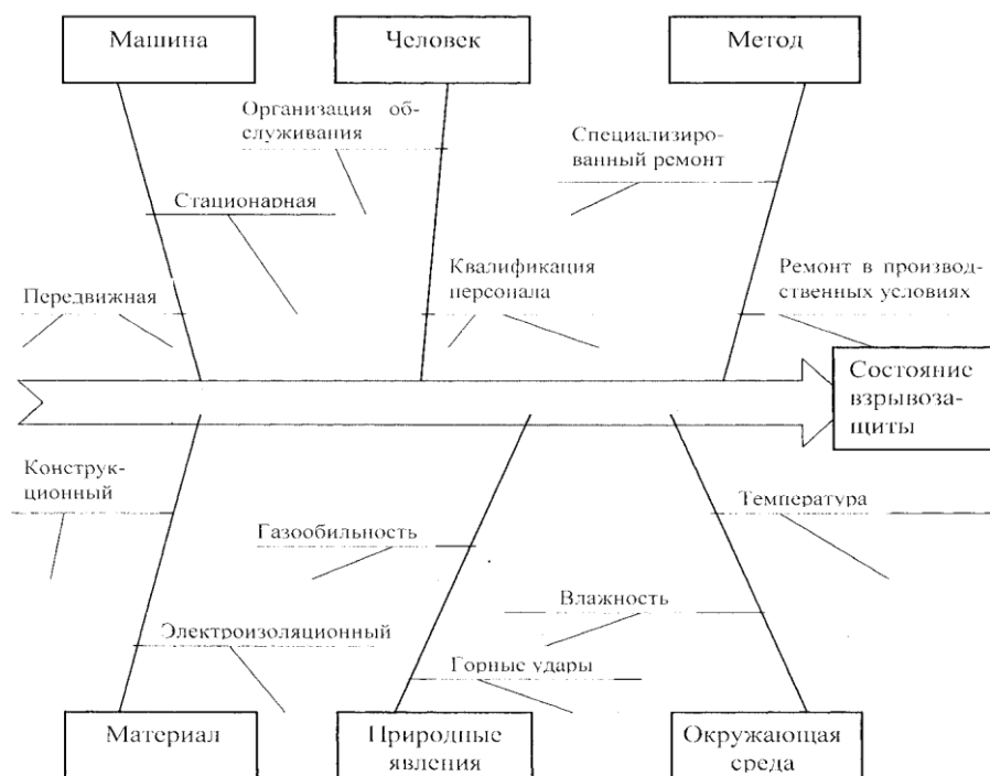
Рис. 1. Диаграмма Ишикавы для анализа влияния условий эксплуатации на уровень взрывозащиты
