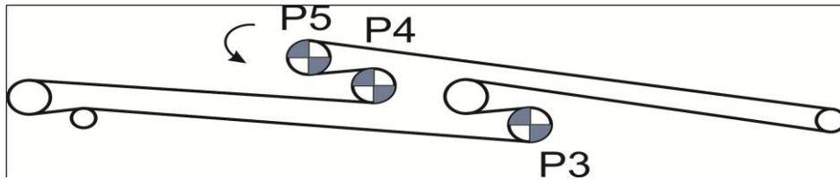
Рис. 7 Схема обводки ленты и размещения приводных барабанов 3ЛЛ1600
