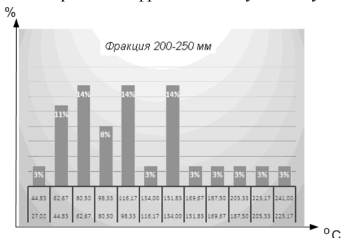
Рис. 2 Гистограмма распределения температуры поверхности транспортируемого материала по фракционному составу 200-250 мм
