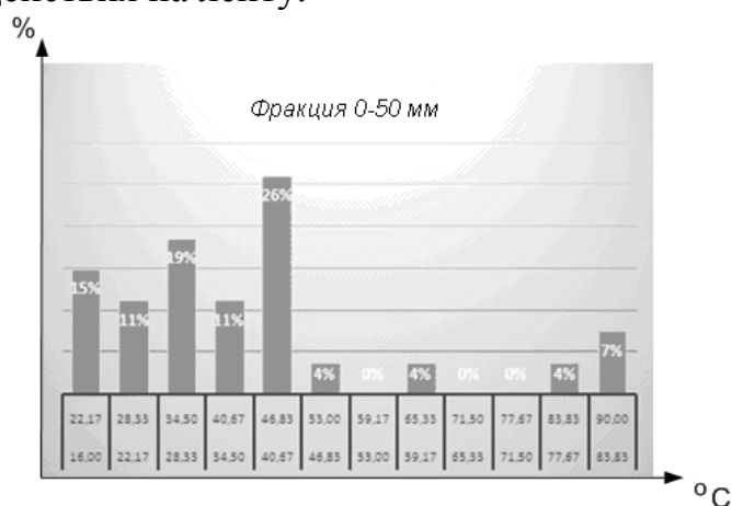
Рис. 1 Гистограмма распределения температуры поверхности транспортируемого материала по фракционному составу 0-50 мм
