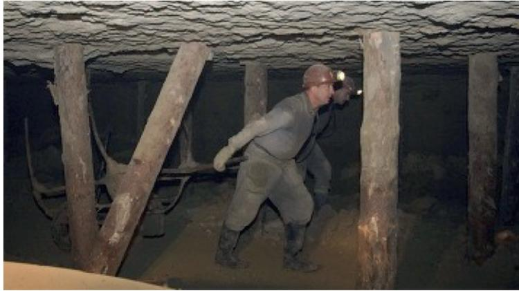
Рисунок 1 – Зависание и крепление кровли
