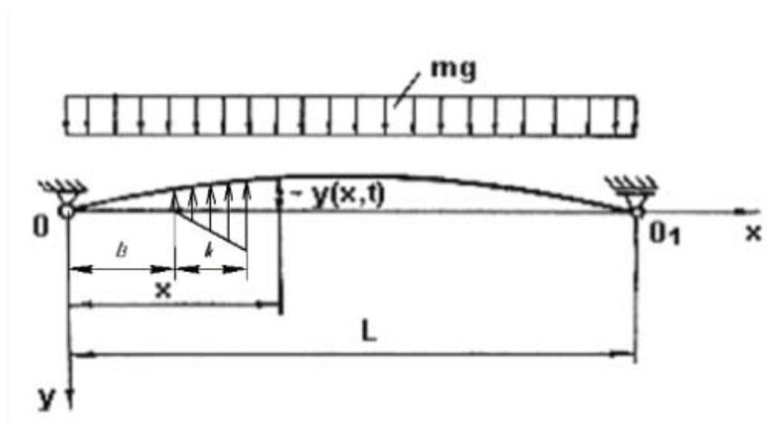
Рис. 2. Расчётная схема блока кровли после хрупкого разрушения
