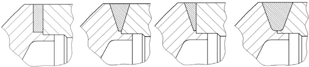
Рисунок 1 - Конструктивное исполнение кромок дна и цилиндра под сварку
