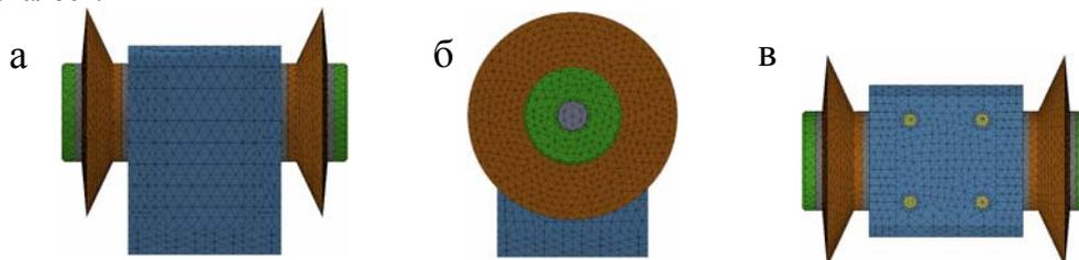
Рис. 1. Конечно-элементная модель четырехгранной призмы и дискового инструмента со стороны: а – забойной грани; б – боковой грани; в – крышки
