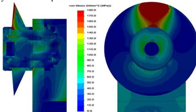
Рис. 2. Распределение эквивалентных напряжений по критерию Мизеса в узле крепления биконического дискового инструмента ( $\varphi = 25^\circ + 5^\circ = 30^\circ$ ) при разрушении породного массива  $\sigma_{сж} = 78,9$  МПа
