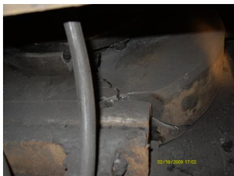
Рис. 1. Излом центральной цапфы экскаватора ЭКГ-10 при воздействии эксплуатационных нагрузок
