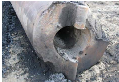
Рис. 1. Излом центральной цапфы экскаватора ЭКГ-10 при воздействии эксплуатационных нагрузок
