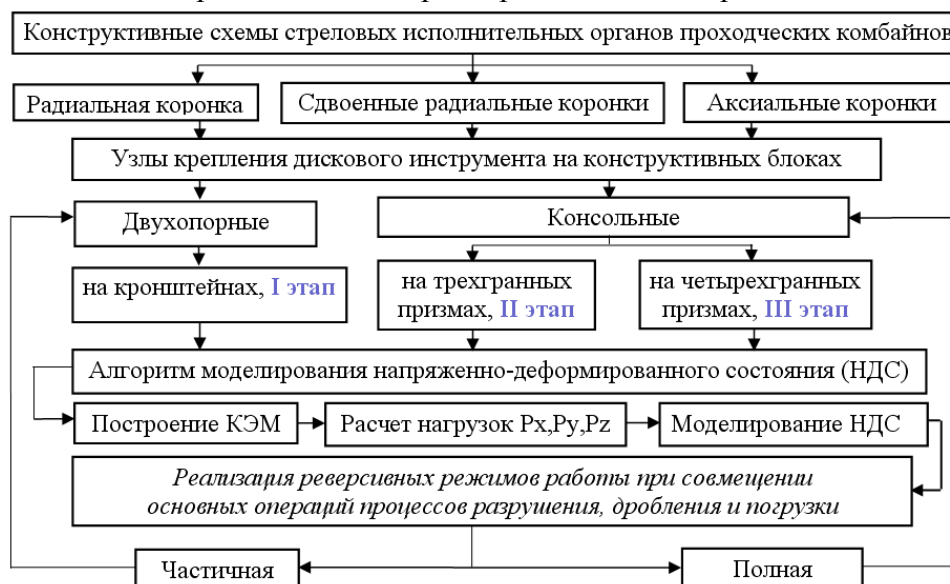
Рис. 1. Основные этапы моделирования напряженного состояния конструктивных блоков с дисковым инструментом стреловых проходческих комбайнов
