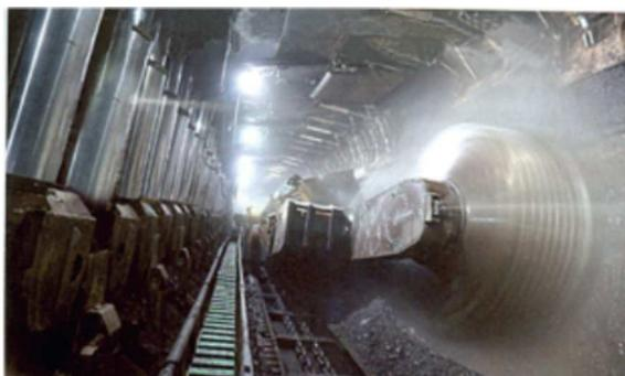
Рисунок 6 - Ненулевая работа СМК с положительным моментом силы, запрограммируемая в монтажной камере
