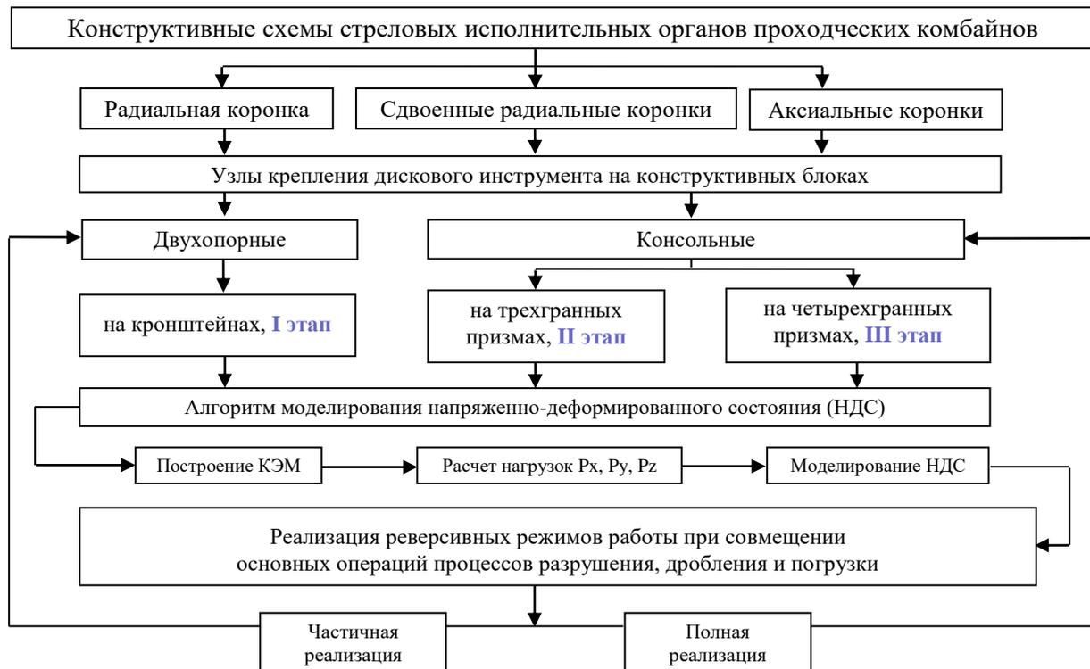
Рис. 1. Обоснование этапов моделирования напряженного состояния конструктивных блоков дискового инструмента на стреловых проходческих комбайнах
