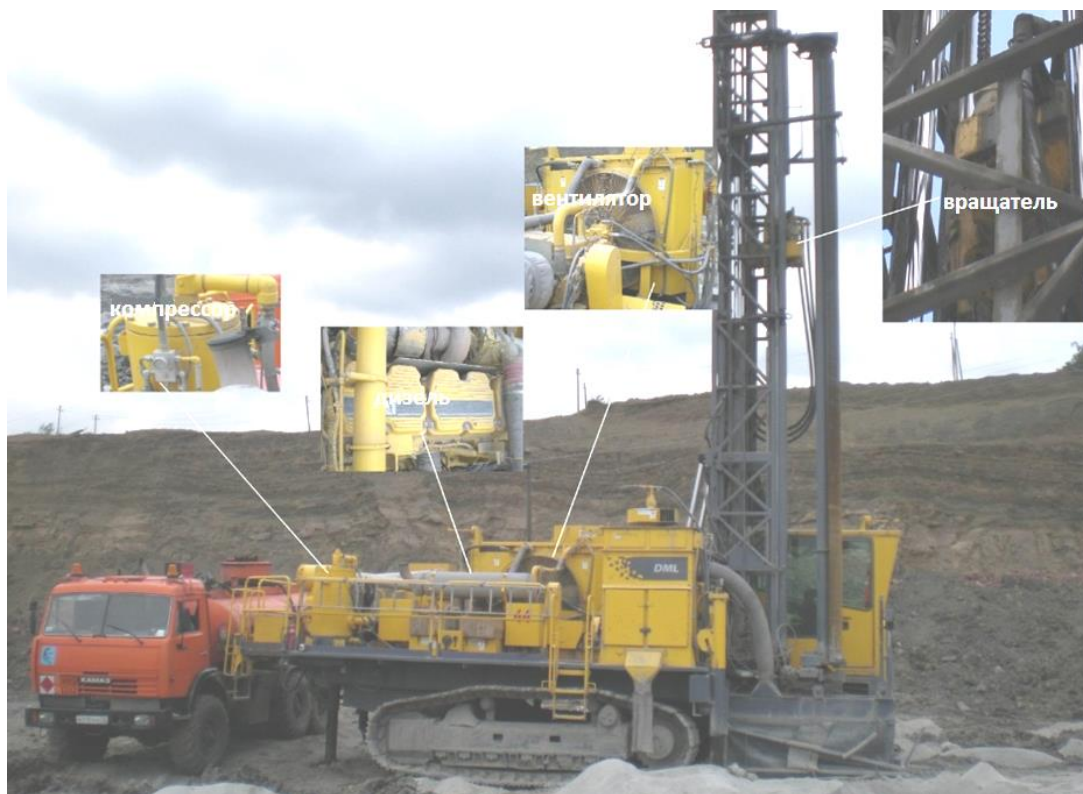
Рис. 7. Объект диагностирования – дизель-гидравлический буровой станок DML-1200
