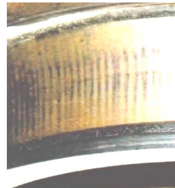
Рис. 11. Признак развитого дефекта подшипника коленчатого вала (а) типа «износ беговой дорожки схватыванием 2 рода» (б)
