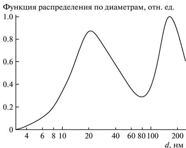
Рис. 1. Спектр размеров наноаэрозоля, измеренного в галерее одной из угольных шахт Кузбасса.
