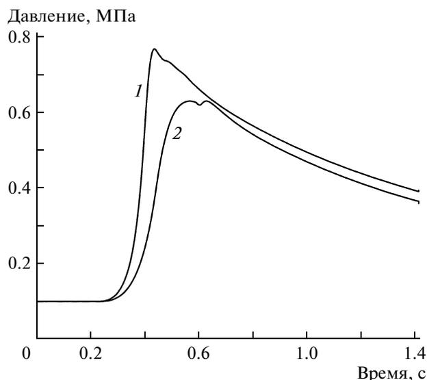
Рис. 3. Зависимость давления в бомбе от времени. Смесь аэрозоль + метан (6.5%) + воздух (кривая 1), метан (6.5%) + воздух (кривая 2).
