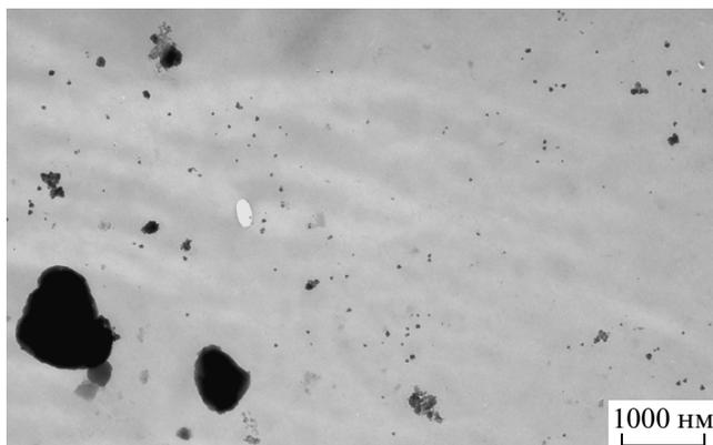
Рис. 2. ПЭМ-изображения аэрозольных частиц, полученных при механическом дроблении угля.
