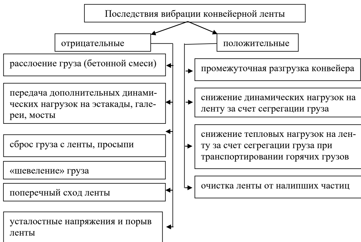
Рис. 2. Последствия вибрации конвейерной ленты Fig. 2. The effects of vibration of the conveyor belt
