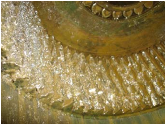
Рис. 5. Дефекты зубчатой передачи в волновом редукторе резания комбайна СМ-130
