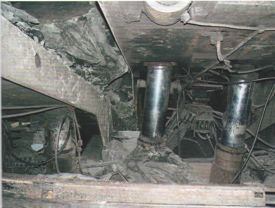
Рис. 5. Зжатие секции механизированной крепи Fig. 5. Clamping of powered support section
