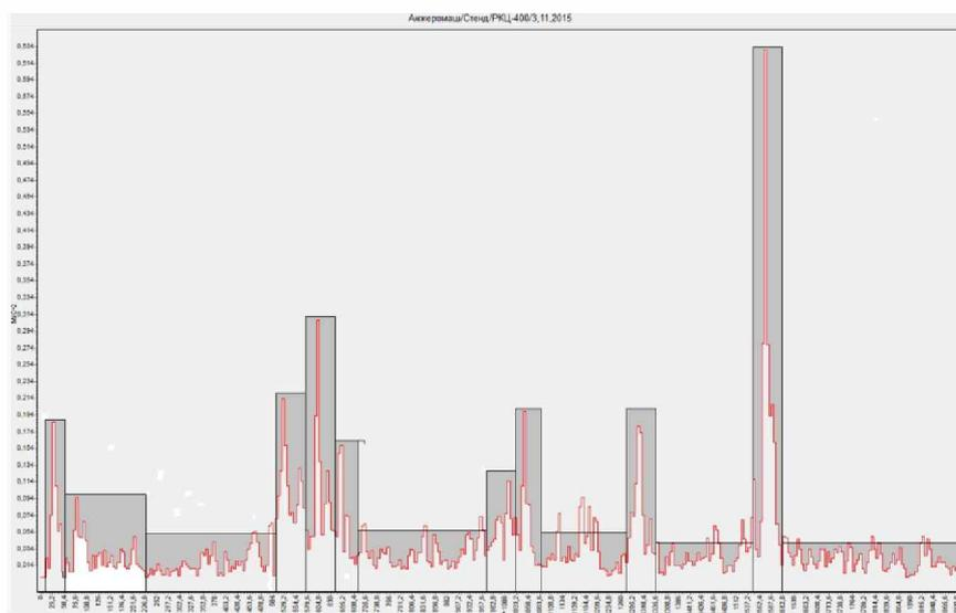
Рис. 2. Спектр виброакустического сигнала, разделенный на 14 частотных полос
