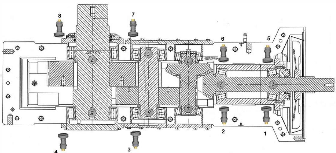
Рис. 3. Схема контрольных точек измерения вибрации на редукторе РКЦ-400
