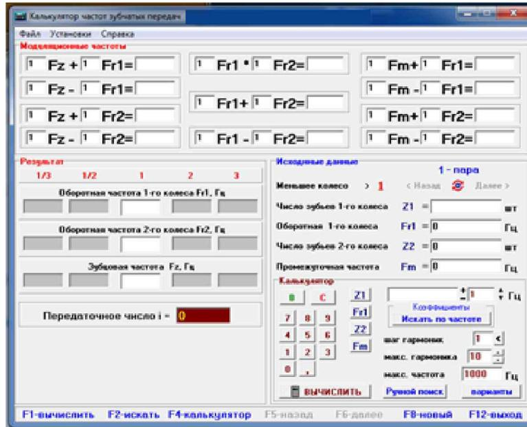
Рис. 4. Калькулятор частот зубчатых передач
