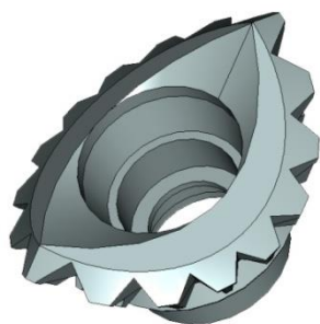
Рисунок 1. Шарошка для бурения скважин с некруглым поперечным сечением.
