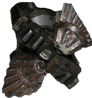
Рисунок 3. Опытный образец режуще-шарошечного инструмента для бурения скважин с квадратной формой поперечного сечения.
