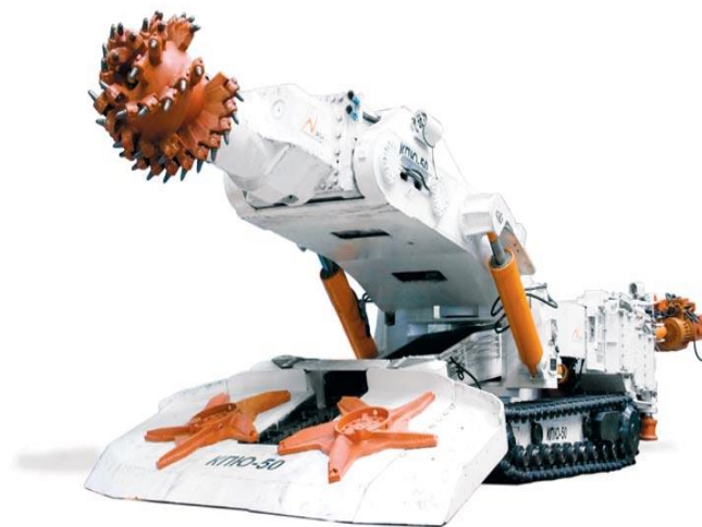
Рисунок 1. Проходческий комбайн КПО-50.
