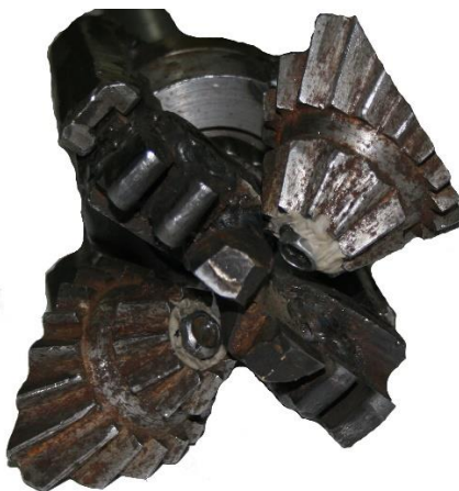
Рис. 3. Макет режуще-шарошечного бурового инструмента для образования квадратного поперечного сечения скважины
