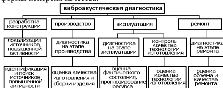
Рис. 1. Области применения вибрационной диагностики на различных этапах жизненного цикла машинного оборудования
