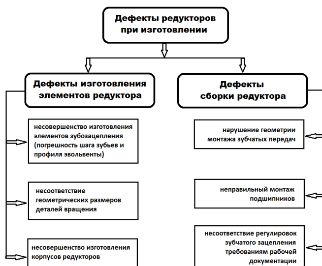
Рис. 2. Дефекты, возникающие в редукторах при изготовлении
